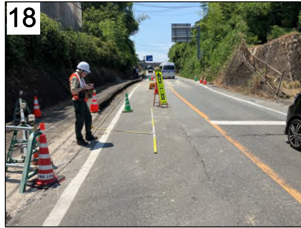
宇城市豊野町山崎の国道218号を横切る地震断層 7) 。道路白線を基準として約135cmの右横ずれ変位が認められる。上下変位は不明瞭。8月2日撮影。
