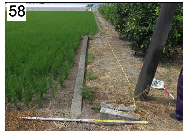
58 氷川町野津の水田を横切る地震断層。 右横ずれ114cm, 縦ずれ49cm (写真手前の東側隆起)。 8月5日撮影。
