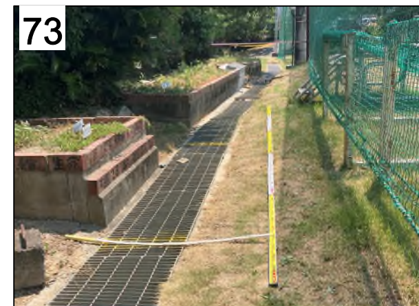
八代市岡町の龍峯小学校にあらわれた地震断層 7) 。 右横ずれ約98cm。上下変位約30cmで、断層近傍はやや撓み上がる。8月3日撮影。
