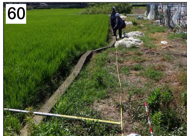
氷川町野津の水田を横切る地震断層。右横ずれ126cm。8月5日撮影。
