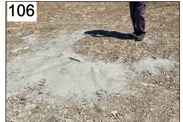
106 八代市協町の空地（旧田地）に認められる噴砂跡。 明灰色の細砂からなり、水が流れ出た痕跡（ガリー）が認められる。噴砂跡は複数個所に認められる。 8月18日撮影。
