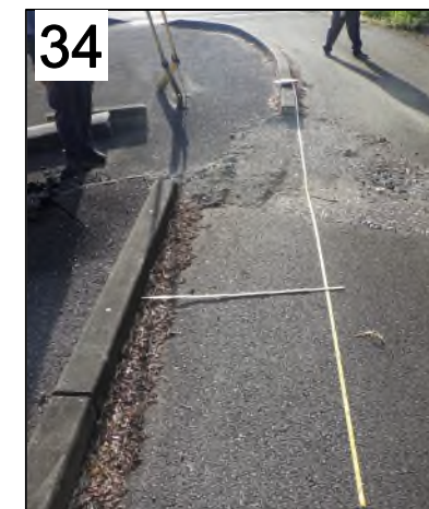
宇城市小川町南部田の道路を横切る地震断層. 右横ずれ91cm, 縦ずれ数cm (写真手前の東側隆起). 8月6日撮影.
