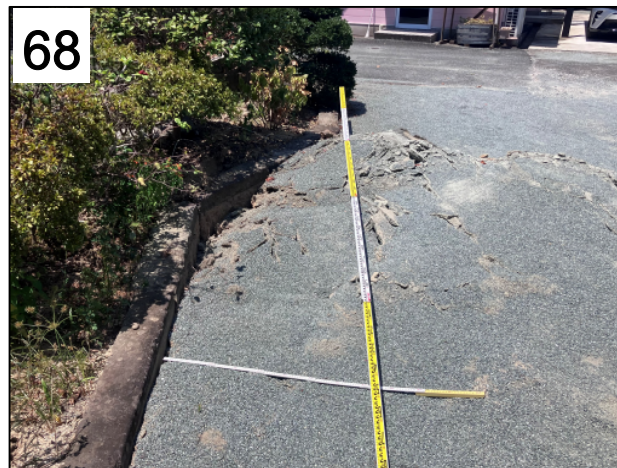
氷川町宮原にあらわれた地震断層 7) 。横ずれ約81cm。断層帯周辺がやや隆起する。8月1日撮影。
