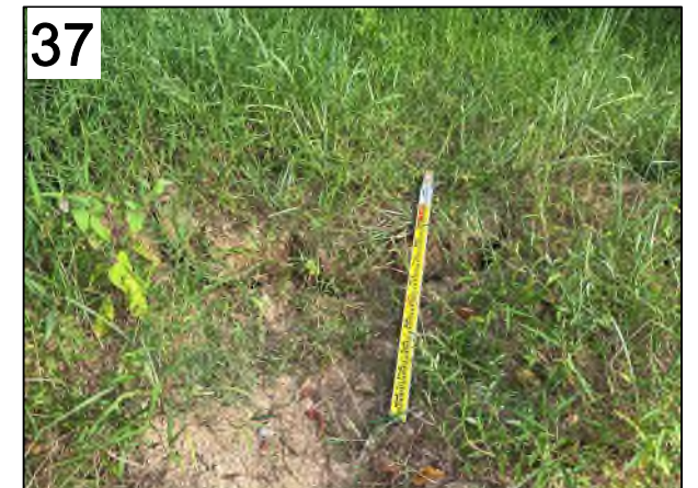
宇城市小川町西北小川の草地を横切る地震断層、約25cmの縦ずれ変位（写真奥の東側隆起）が認められる、8月6日撮影。
