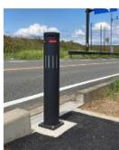
IoTセンサモニタリング（冠水センサ）
