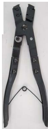
新しい工具 LP型 (18600-1071) LP型対応止め輪番号 (18010-0013)
