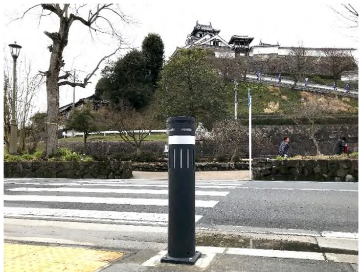
実証試験中の冠水センサ付きポラード
