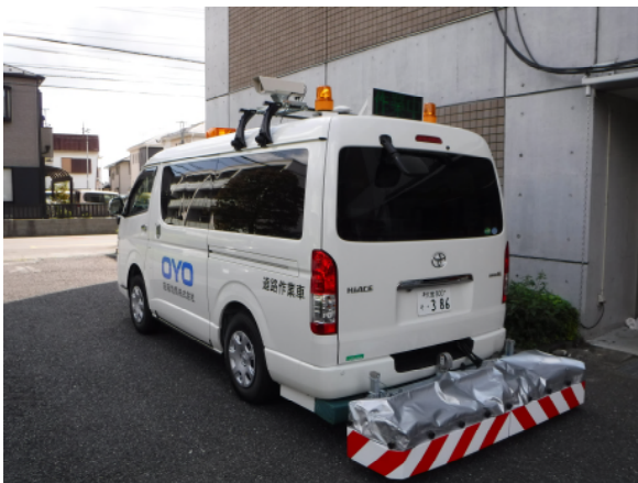
路面下空洞探査車
