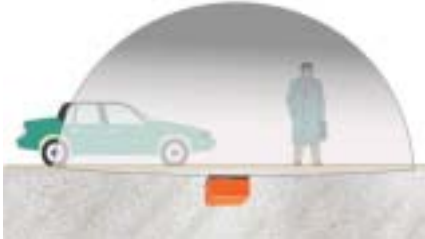
侵入監視システム「CMD 1」(Concealed Motion Detector) 地面に埋め込んだCMD 1で人や車などを検知するイメージ
