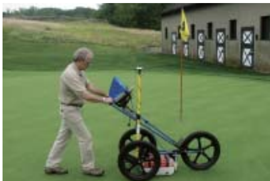
レーザー装置でゴルフ場の排水管を探索している状況（GSSI社製）
