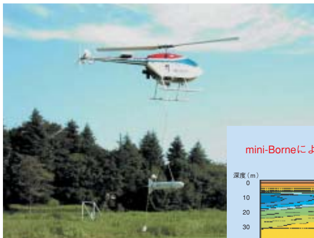
地すべり調査などで活躍が期待される新しい空中探査法「OYO-mini Borne」。搭載するセンサーの小型・軽量化を図り、ラジコンヘリコプターに吊り下げての調査が可能になった。
