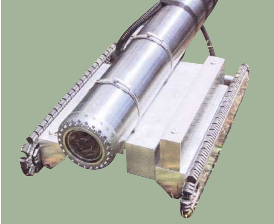
米国の子会社 - Clearsafe, Inc. との共同開発による自走式下水管診断システム。 欧米での事業展開が期待される。
