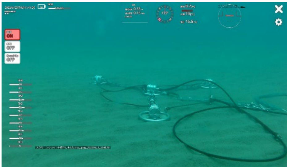
極小海底微動アレイ探査の探査状況
