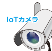
設置イメージ 冠水センサ部との連動により、スイッチが入った際に撮影します。
