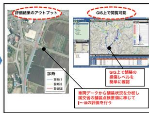
応用地質では、コネクテッドカーを活用した新たな道路舗装維持管理手法を提案します。コネクテッドカーとは、インターネットへの常時接続機能を具備した市販車であり、通信機能によって車両や道路状況などの情報を常時発信しています。これらの車両が走行中に発信する情報をビッグデータとして集計することで、道路の異常箇所などがリモートで把握することができ、自治体による道路メンテナンスの作業を大幅に効率化・省力化するとともに、舗装状況調査の費用を従来の1/5程度まで削減することが出来ます。
