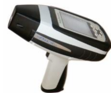
アスベストアナライザーによる現場簡易診断
