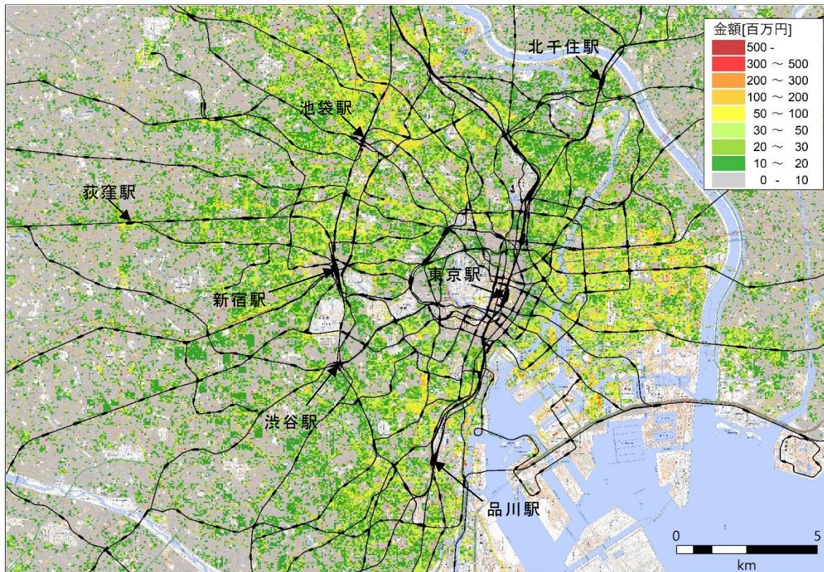
図 25 50m メッシュ別非木造 1971~80 年築住宅ストック（粗ストック：東京） ※背景に地理院タイル（ https://maps.gsi.go.jp/development/ichiran.html ）を使用
