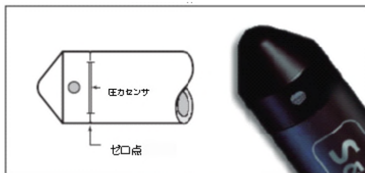
図 S&DL mini 圧力センサゼロ点
