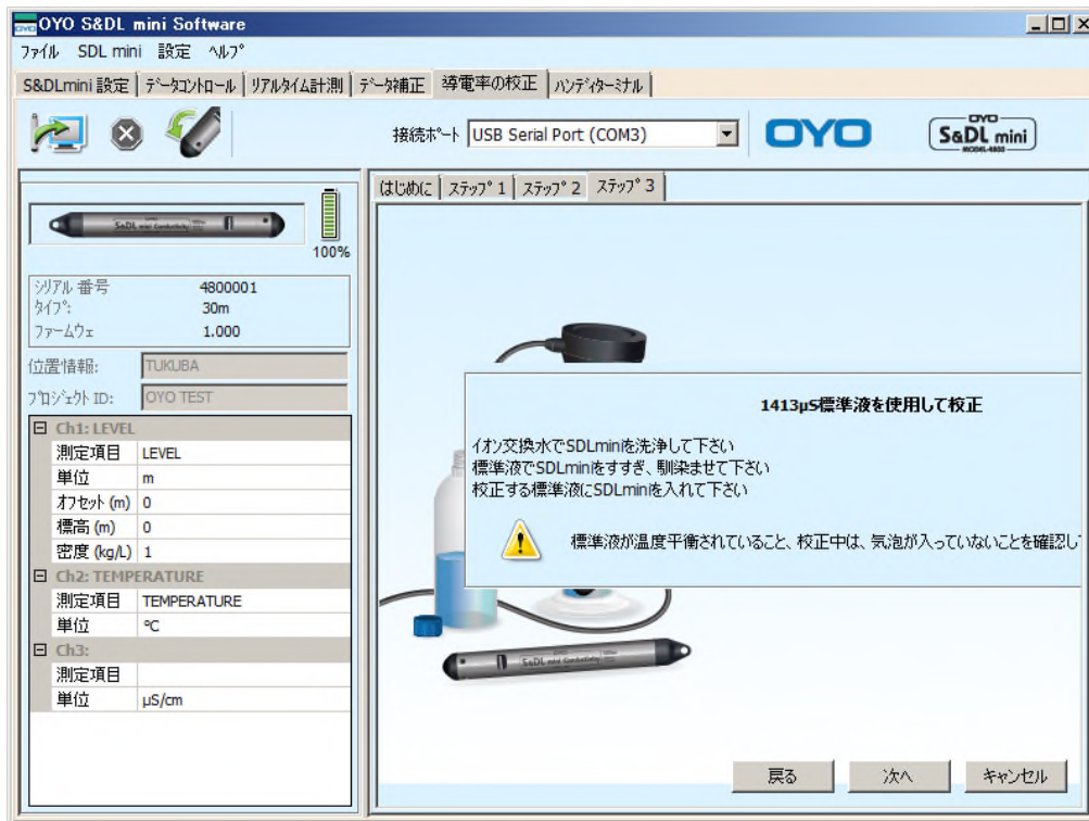
図 13-4 S&DL mini 校正ウィザード ステップ3 (1413 \mu\text{S}/\text{cm} の標準液を使用して校正を実施した場合の例)
