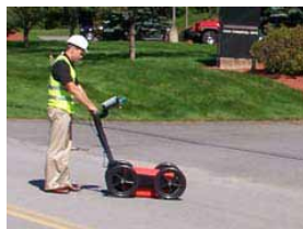
■ 270MHz アンテナを利用した配管探査：深度約 2m まで
