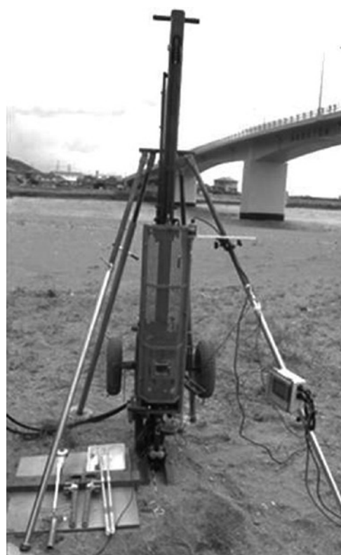
写真-4-2 オートマチックラムサウンディング（SRS）の装着状況 Photo. 4-2 PDC on Swedish ram sounding (called "SRS")
