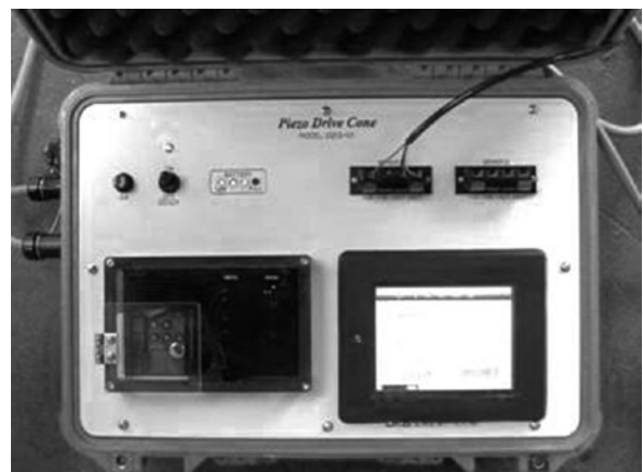
写真-5-3 汎用型PDCのデータ収録装置 Photo. 5-3 Data logger of universal type PDC
