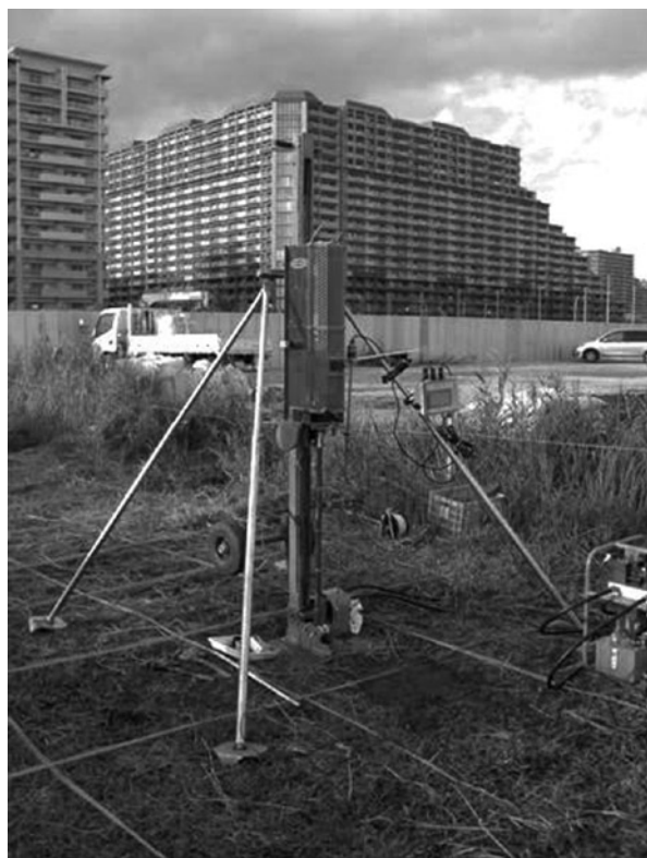
写真-4-1 軽量型ラムサウンディング（ミニラム）の装着状況 Photo. 4-1 PDC on lightweight ram sounding (called "Mini Ram")
