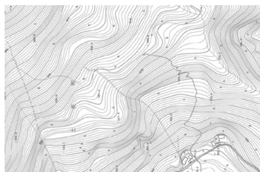
(2) 航空写真測量による地形図
