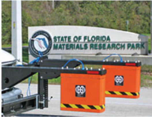
図-21 米国でのホーン型アンテナの車載状況
