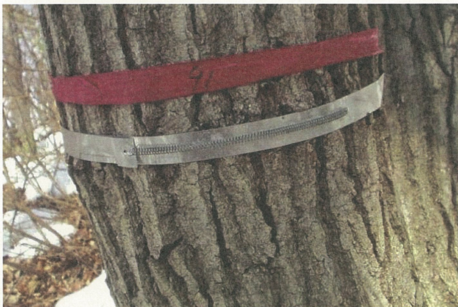
図-13 樹木に設置したデンドロメーター
