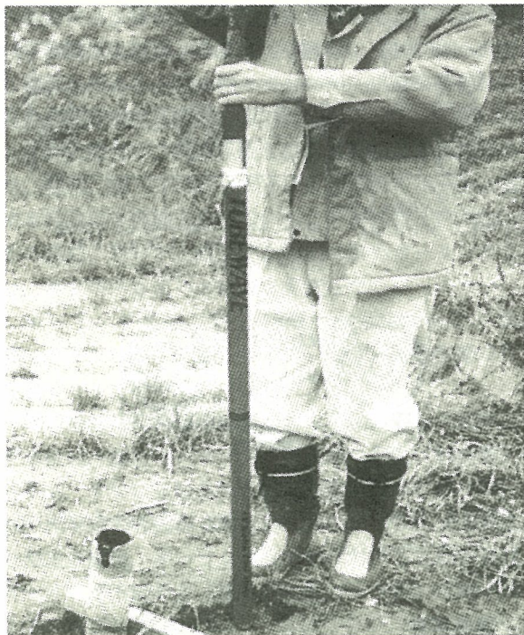
写真-1 ボアホールアンテナ Photo 1 Borehole antenna
