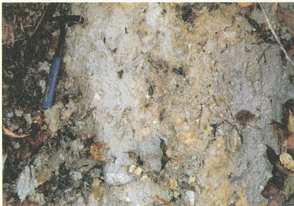
図-7 径数cmから20cm大の礫を含む砂質粘土
