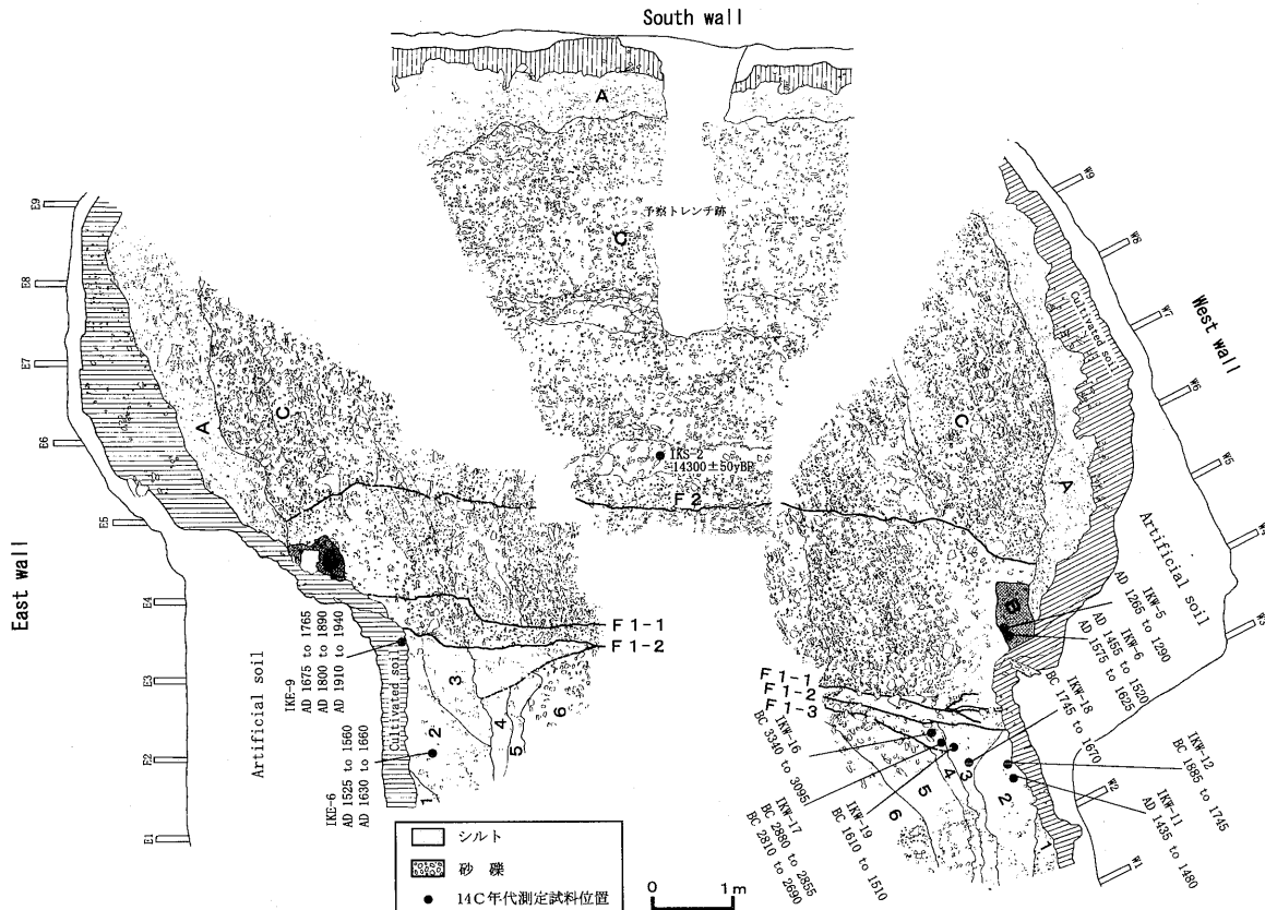
図-11 池ノ浦トレンチ壁面のスケッチ
