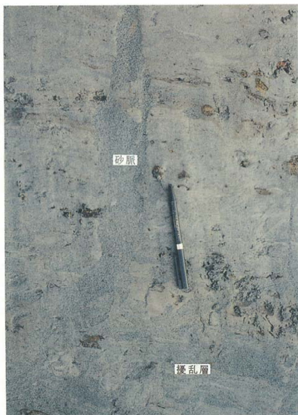
写真-1 段関・大代トレンチ底より実施したジオスライサー調査で採取した試料。I層下方の中粒砂ないし粗粒砂が液状化の発生源である。
