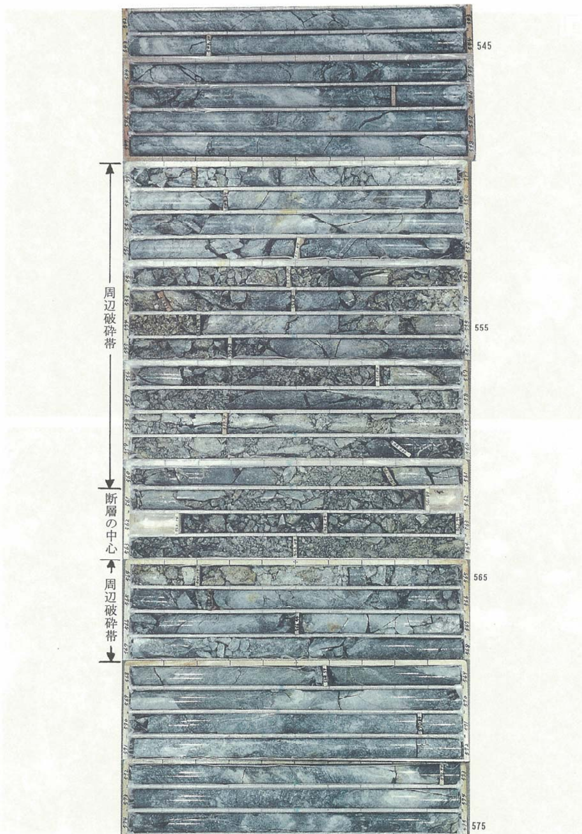
図版-8 Bヨ-1孔ボーリング・コアに見られる断層の写真(549m~568m深度)。断層の中心は未固結ガウジを伴う主変位帯、断層の周辺破砕帯は岩片からなり殆ど変位を賄わない帯。
