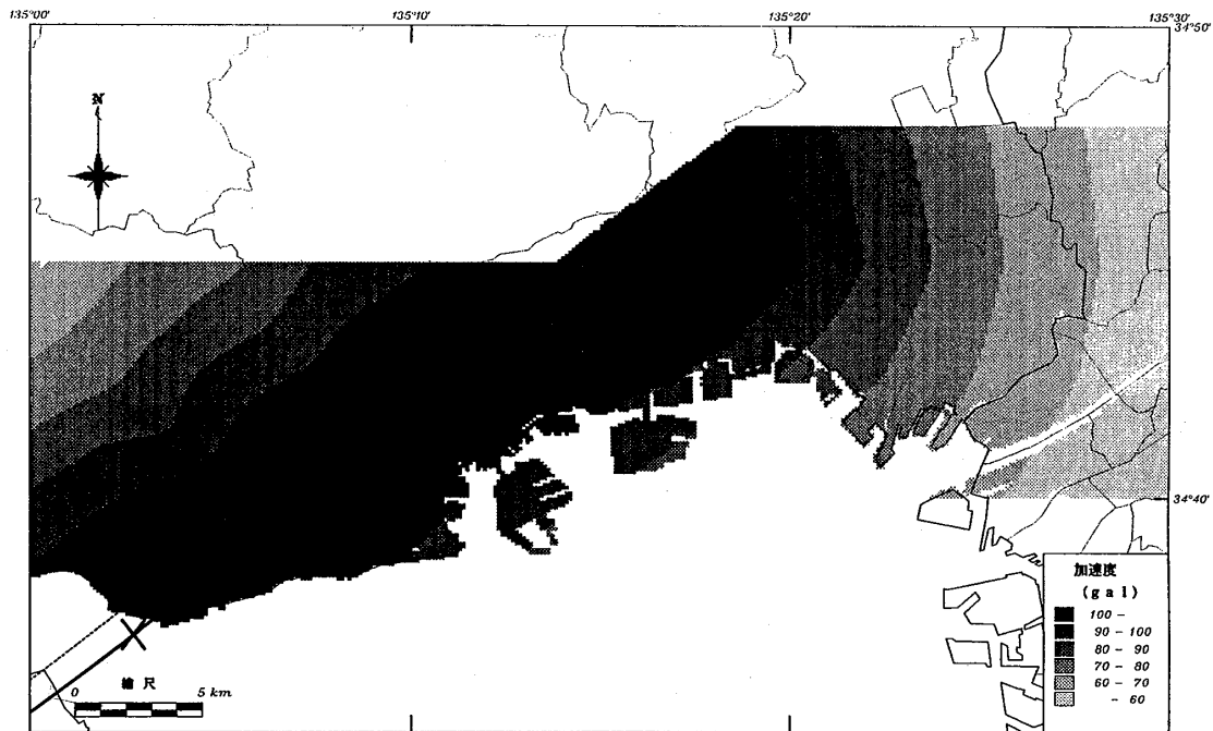
図-3 推定基盤入射加速度分布 (阪神地域)
