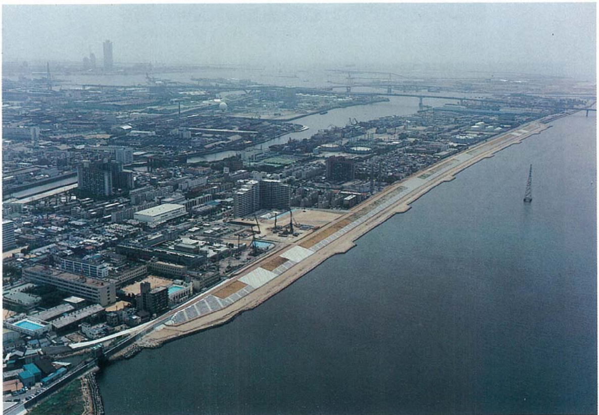
大阪市此花区、上記淀川左岸堤防(西島地区)の復旧後の状況。
