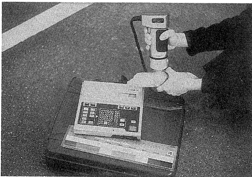
図-5 色彩色差計 (CR-200) Fig. 5 Chromometer (Minolta CR-200)
