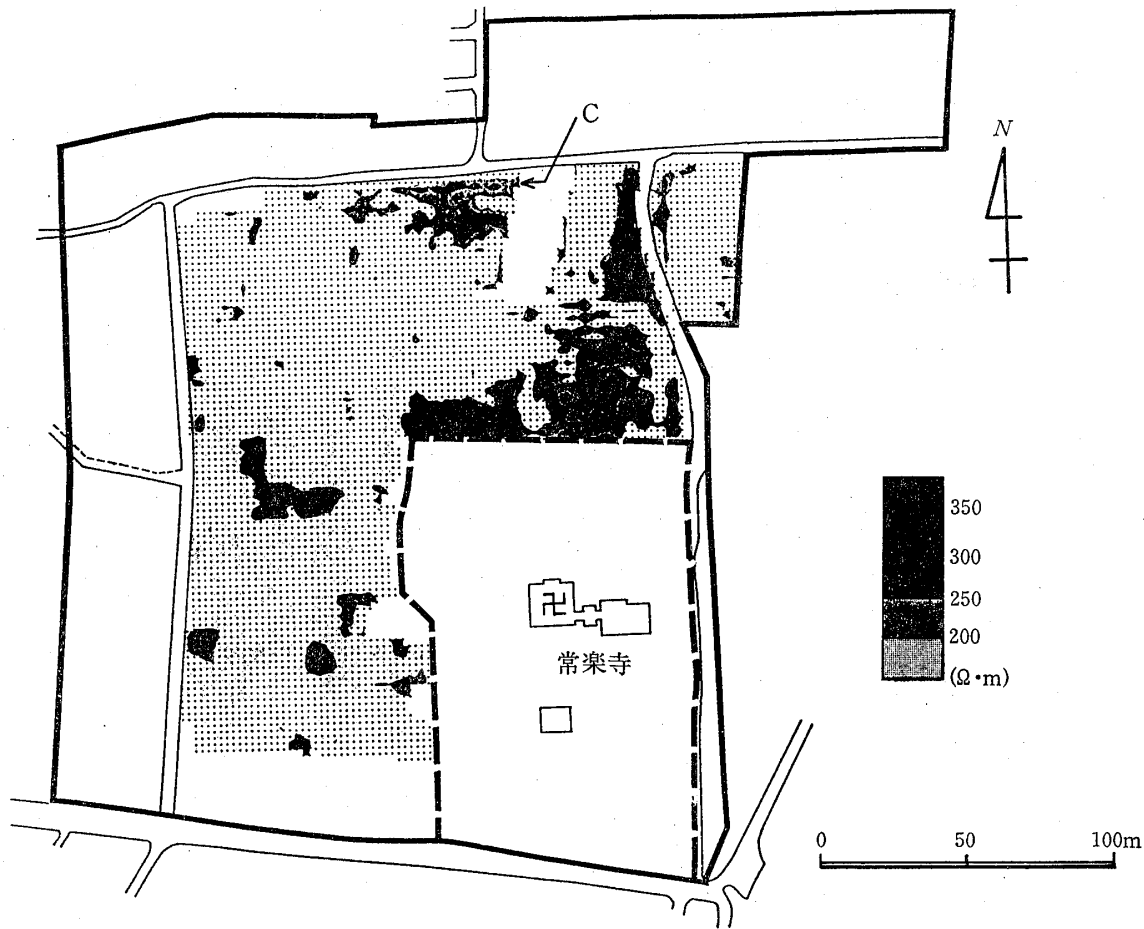
図-5 河越館跡における見掛け比抵抗分布 (電極間隔 90cm)
