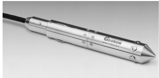
図9 孔径変化法に用いる3成分ゲージ (USBM ゲージ) 31)
