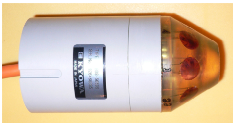
図20 円錐孔底ひずみ法に用いる24素子ひずみ計
