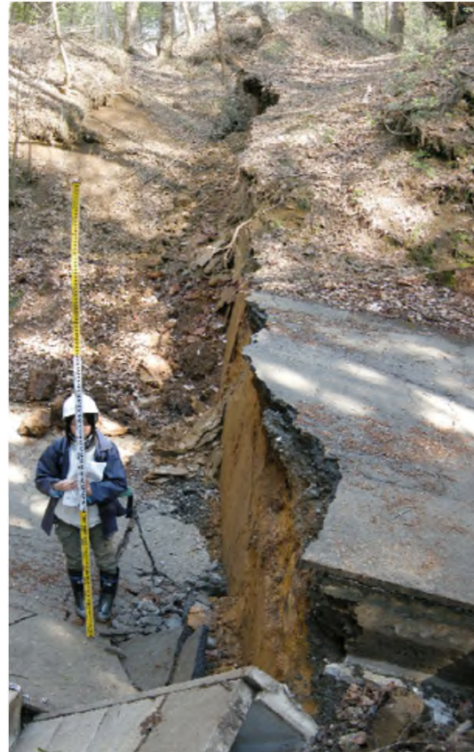
井戸沢断層(福島県いわき市内陸部) 平成25年4月11日 M7.0の地震で地表 地震断層(正断層)が出現
