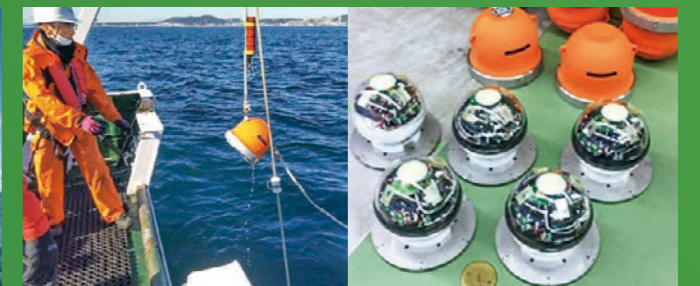
大水深対応型海底微動アレイ探査(日本海洋事業(株)と共同開発)
