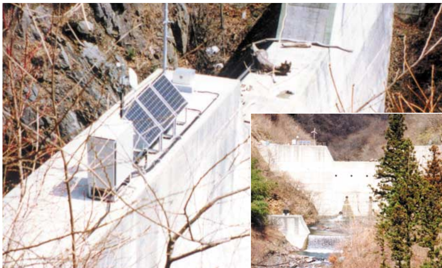
砂防ダムの地震時の揺れを常時監視。キネメトリクス社（米国会社）の強震計をベースに衛星携帯電話・ソーラーパネル等を組み込み、リアルタイムでデータを収集。
