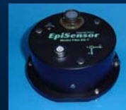
K-NETで採用されたものと同じタイプの地震計
