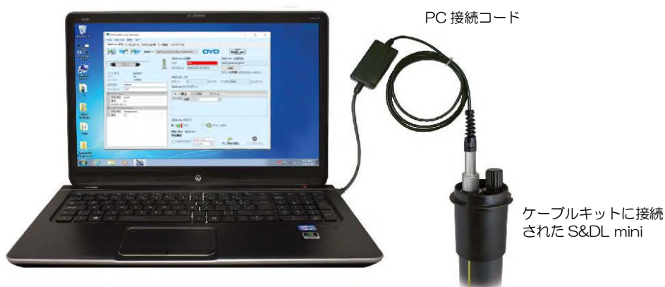
PC 接続コードを使って S&DL mini とケーブルキットを PC に接続する
