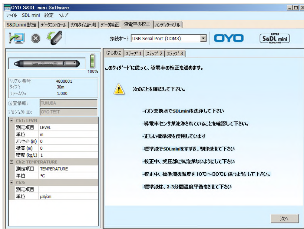
図 13-1 S&DL mini 校正ウィザード開始画面
