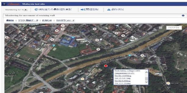
専用の i-SENSORクラウドサービス(有料)をご契約いただくと、センサーデータがインターネットで閲覧(デジタル値表示、グラフ表示)が可能です。また複数センサーにまたがったしきい値設定や、アラートメール送信先設定、センサーデータの電子化ファイル出力(TSV)が可能です。
