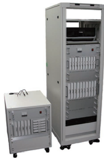
図-2 比抵抗モニタリング用計測システムの外観 (左：10CH システム, 右：20CH システム)
