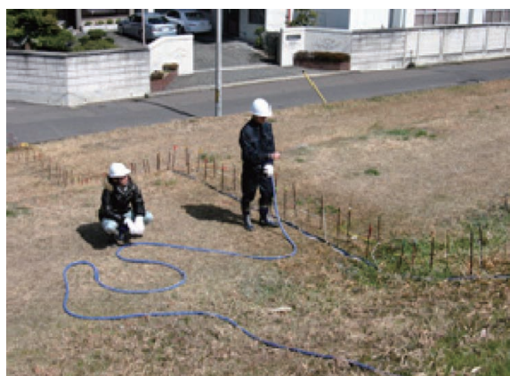
図-7 散水実験状況
