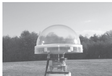
図-10 アンテナレドーム
