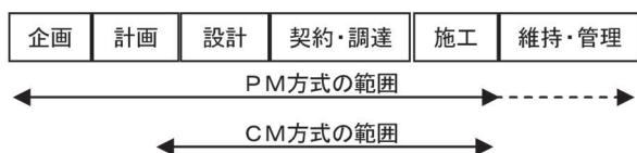
図-1 PM方式とCM方式の説明図 1)
