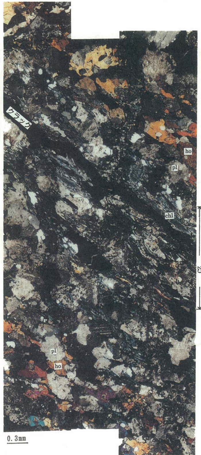
図-16 一軸圧縮試験により変形した片麻岩（試料31）に形成されたクラック周辺の顕微鏡写真。クラックの母岩はカタクレーサイト化した黒雲母片麻岩とそれを取り巻く弱くカタクレーサイト化した角閃石片麻岩。クラック：一軸圧縮試験によって形成されたシアクラック（変位量=約0.3mm：左横ずれ剪断），ho：普通角閃石。
