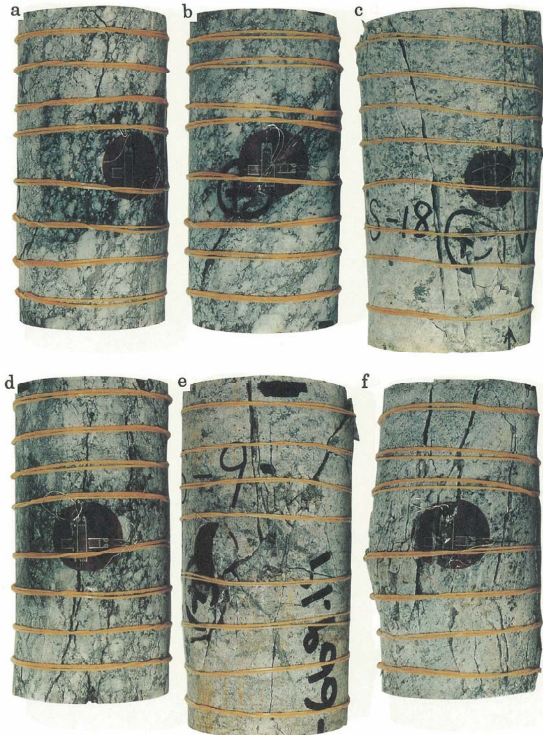
図-11 一軸圧縮試験により変形した6花崗岩試料 (a = 試料4, b = 試料10, c = 試料29, d = 試料3, e = 試料14, f = 試料27)。
