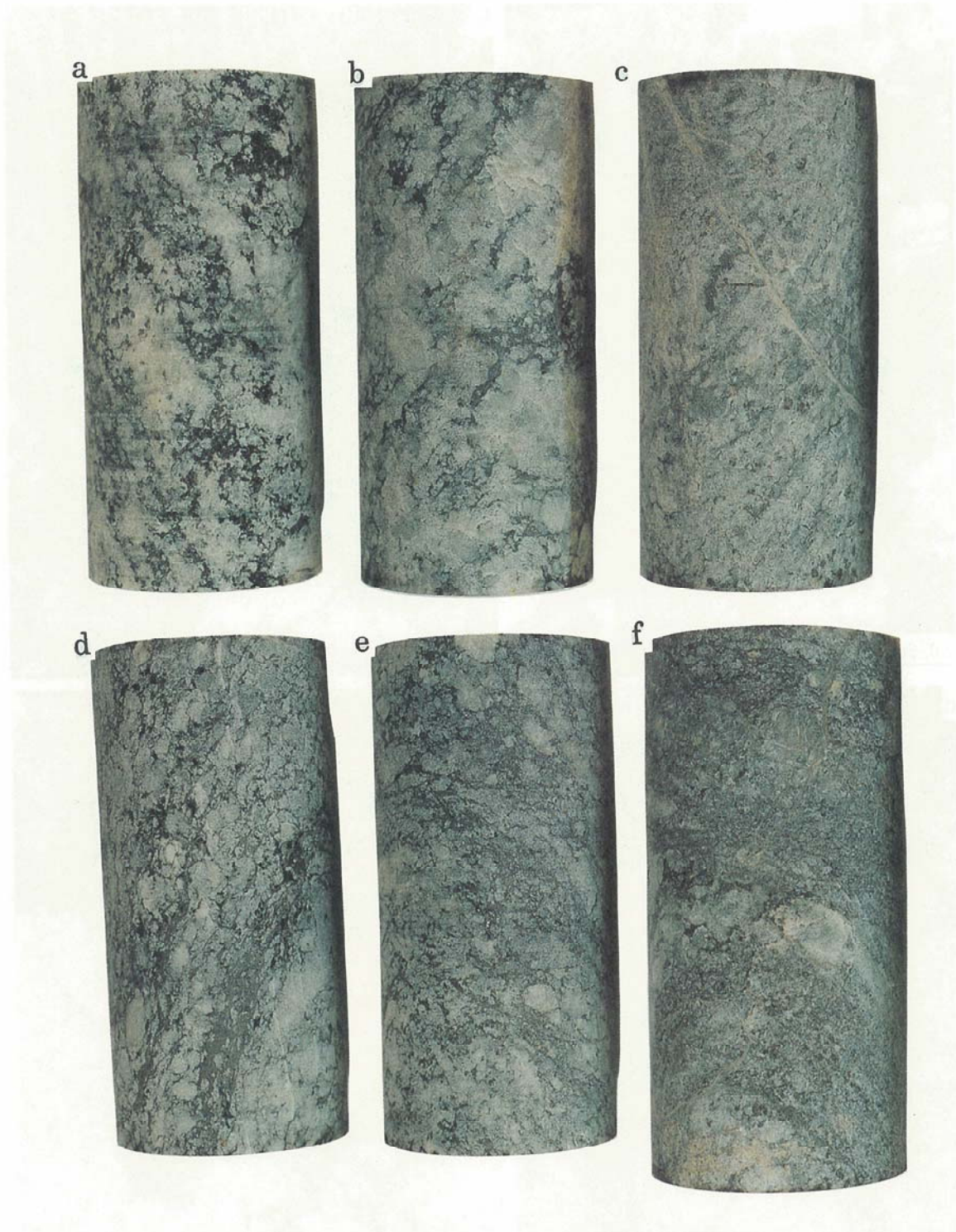
図-2 一軸圧縮試験に使用した6試料：カタクレサイト化をほとんど受けていない花崗岩（a=試料15, b=試料19, c=試料24）とカタクレサイト化を強く受けている花崗岩（d=試料4, e=試料10, f=試料30）
