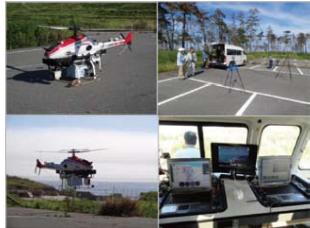
図-8 自律型無人ヘリコプター測定システム (上左:無人ヘリコプター, 上右:アンテナ, 下左:測定飛行状況, 下右:制御装置)
