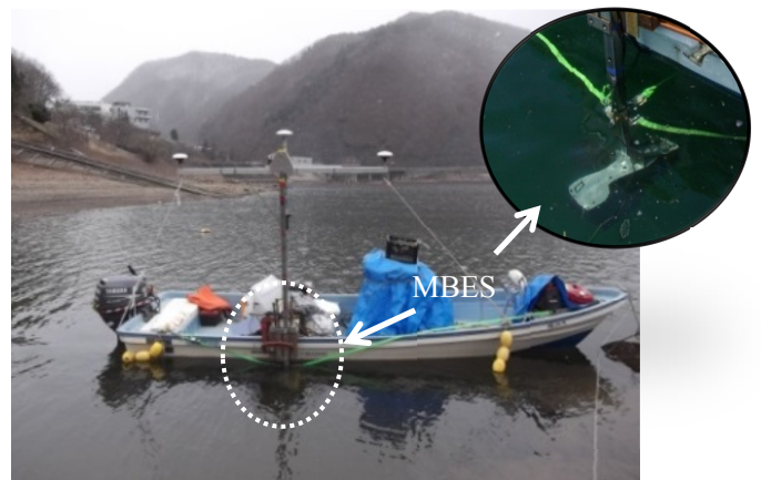
図1 船外機船への MBES 機装例
