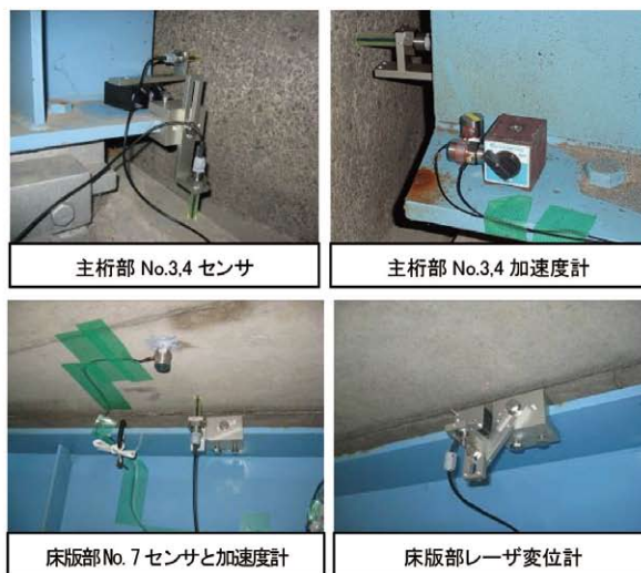
図-6 センサ配置図および取り付け状況 Fig. 6 Sensor layout and installation
