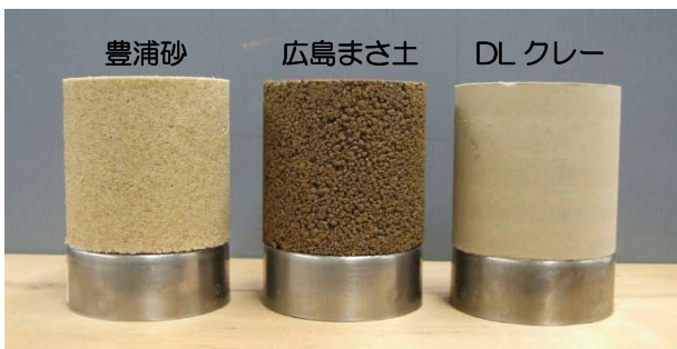
写真-7 締め固めによって作製した供試体の状況 Photo 7 Specimens prepared by compaction
