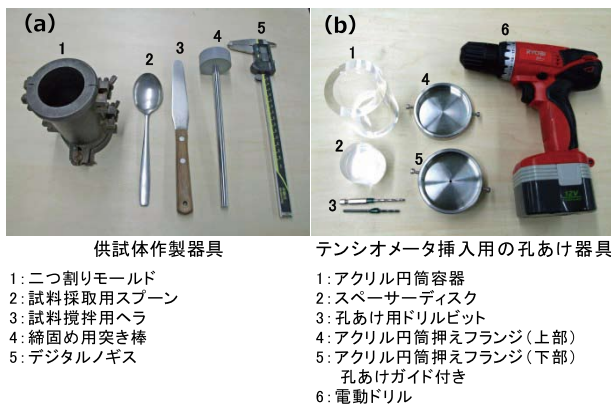
写真-4 供試体の作製に使用する器具 Photo 4 Tools used for specimen preparation
