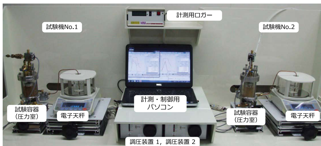
写真-1 試験装置の全景（連続加圧方式による保水性試験装置）
