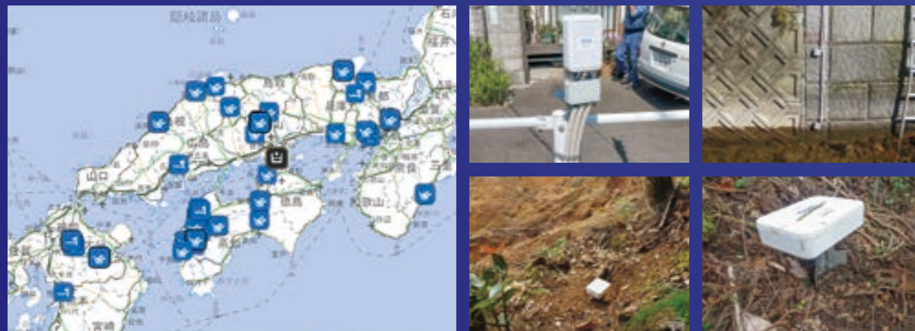
ハザードマッピングセンサ(冠水センサ、傾斜センサ)とセンサ情報管理画面
